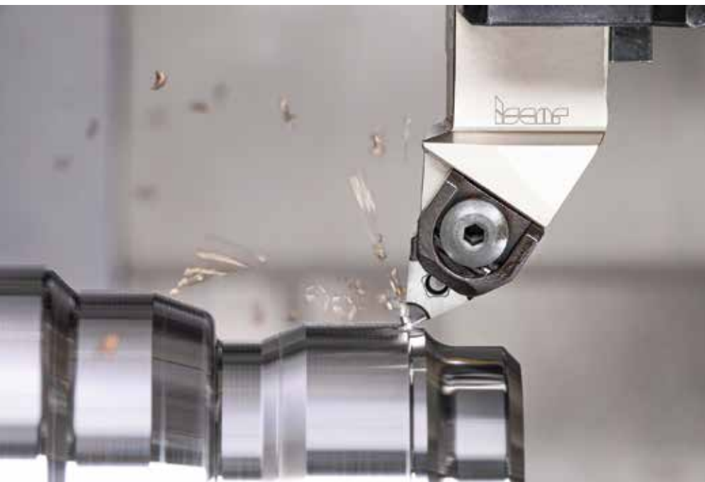
Bild 3 LOGIQ-6-TURN nytt innovativt svarvskär med 6 skäreppor för kostnadseffektiv medelfin och finsvarvning med fokus på hög ytfinhet
